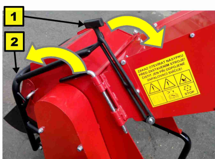
Obr. 4: Vypnutí náhonu rotoru drtiče
