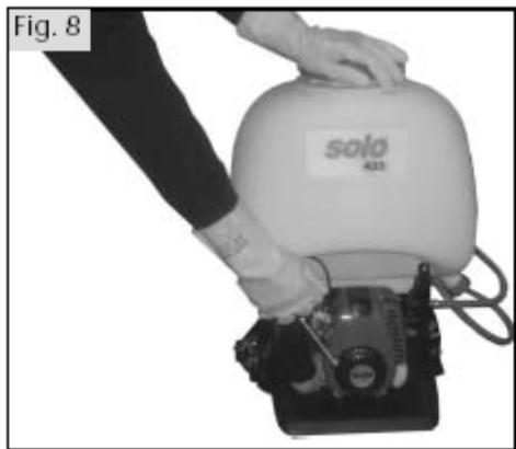
Postavit motorový vysokotlaký postřikovač na zem. Zaujmout bezpečné postavení a dbát na dobrou pozici stroje. Zkontrolujte zda rukojeť na postřikové trubce není zaklapnuta na trvalé postřikování. Ruční ventil musí být při startování zavřený.
